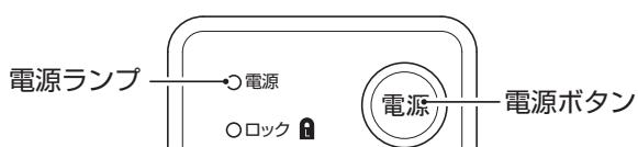
手元スイッチの電源ボタンを押すことで各操作ができるようになります。（電源ランプ：緑点灯）
