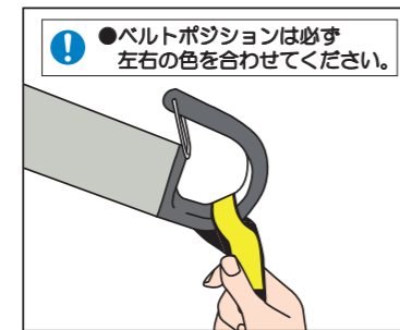
(5) 吊りベルトが、左右のスリングフックにしっかりと掛かっていることを確認します。 ●ベルトポジションは必ず左右の色を合わせてください。
