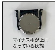
電池 マイナス極を上、プラス極を下にして カバーに入れる
