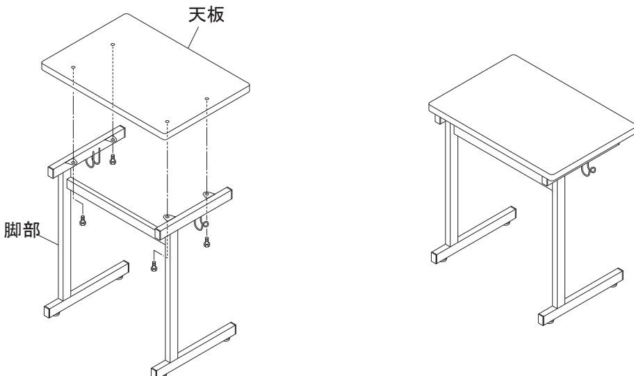
②取付ボルトM6×15を使用し脚部と天板を取付けます。
