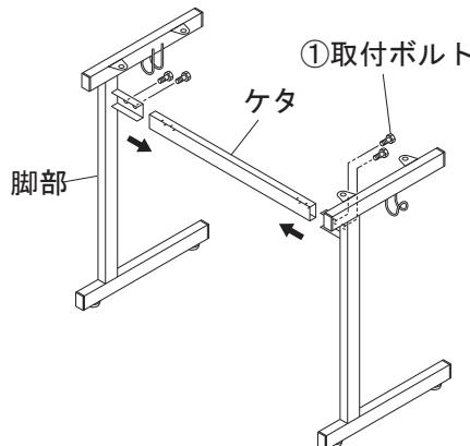
①取付ボルトM8×15を使用し左右の脚にケタを取付けます。
