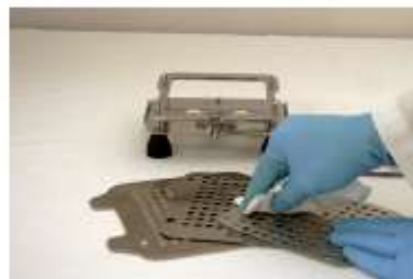
3. ブラシやクロス、掃除機、圧縮空気などを使い、フィラーベース、スペイサー、ボディシート、タンパーから粉末を除きます。
