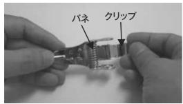
①金具を裏返しにして、バネからク リップを右に開いて「パチン」と 外します。
