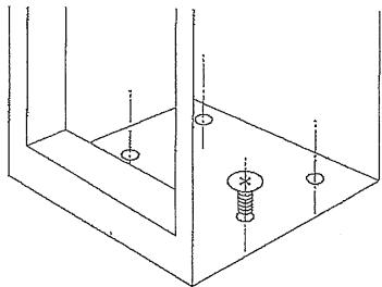
底面にある4ヶ所のビス穴に、付属のタッピングビスで内側から下の台に固定してください。
