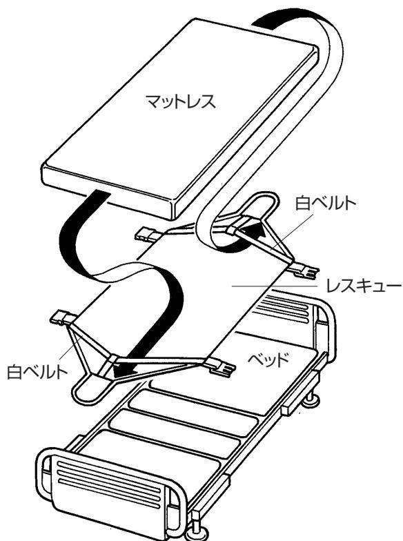
② 緊急時すぐに引き出せるように、赤ベルトのバックルはマットレスの下に隠れないように置いておきます。(通常時ベッドはこの状態で使用します。)
