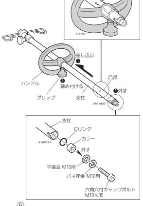
**4.**ベースの穴に支柱を、図のように差し込んでください。 このとき、支柱の凹部をベース 穴内にある凸部に差し込んでく ださい。
