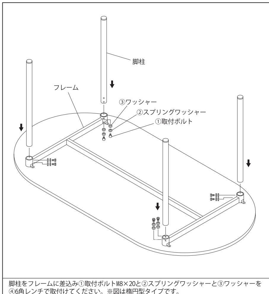
脚柱をフレームに差込み①取付ボルトM8×20と②スプリングワッシャーと③ワッシャーを
