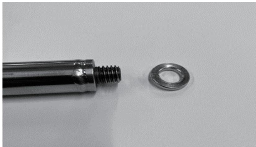
2. ベースの中心にワッシャー（大）を取り付け、その上から外パイプを差し込み、ベースの後側から1項で外したワッシャー、ボルトの順で差し込み、ボルトを工具（別途準備）でしっかりと締めてください。
