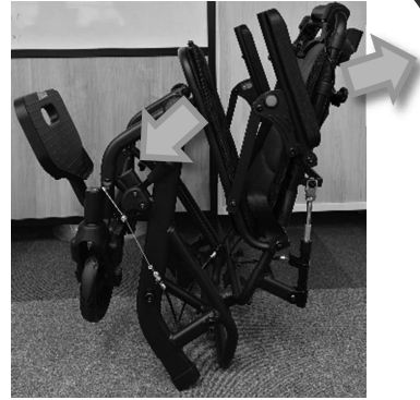
介助ハンドル部分を押さえながら 座面部分を押し下げ本体を展開します
