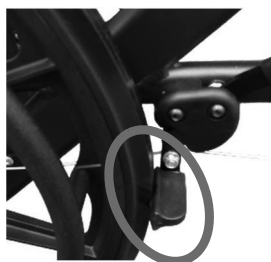
駐車ブレーキ作動
