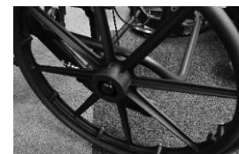
後輪ホイール真ん中のボタンを押しながら 後輪軸を本体に差し込みます
