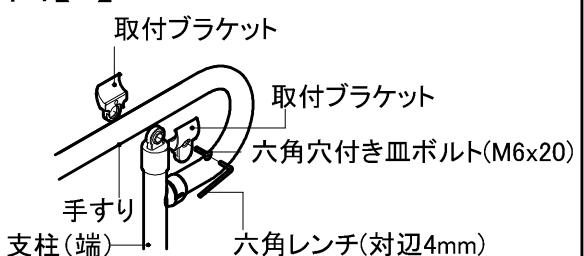
取付ブラケットで手すりと支柱(端)を挟み込み、六角穴付き皿ボルト(M6×20)を六角レンチ(対辺4mm)でしっかりと締め付けてください。
