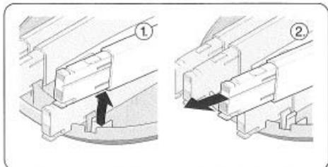
支柱の部品を上にあげて(①)からスライドさせて(②)、それぞれの凹凸を組み合わせさせて組み立ててください
