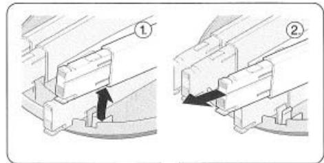
支柱の部品を上にあげて(①)からスライドさせて(②)、それぞれの凹凸を組み合わせて組み立ててください
