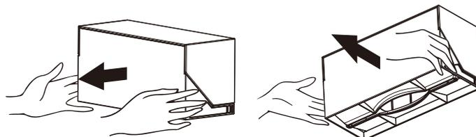
壁付・天井付ともに、カバー（黒色）の角を両手で挟みながら手前に引くと、カバーがスライドして取り外せます。カバー内にペーパータオルを補充し、カバーを逆の手順でスライドさせて取り付けます。
