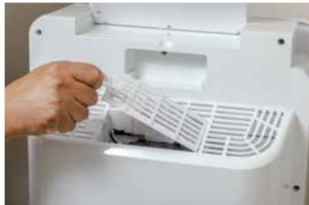
止めフックを指で押さえながら上へ引き上げてカバーを取り外します。
