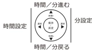
時間が点滅している間に、リモコンで発生時間を設定してください。3時間であれば03:00 5時間半であれば05:30などになります。設定時間に合わせたら、リモコンの保存/決定ボタンを押して確定してください。
