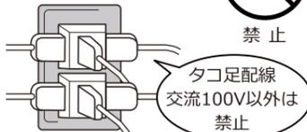
タコ足配線 交流100V以外は禁止 | 濡れた手で機器の操作や電源プラグの抜き差しを行わないでください。<br>感電の原因になります。<br>
