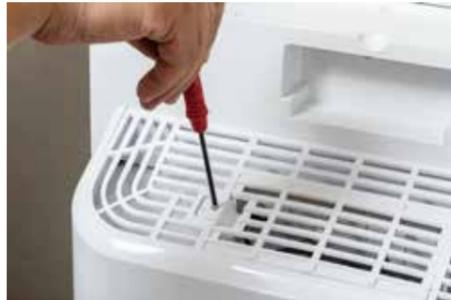
写真の位置のネジをプラスドライバーで緩めてください
