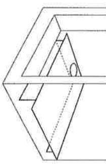
金庫底部の置き台です。丸穴を上側にして、差入れてください。庫内底部が入口部と同じ高さになります。
