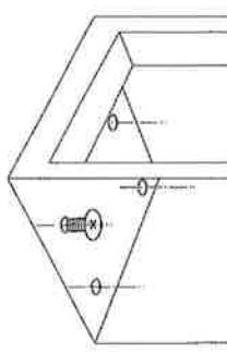
底面にある4ヶ所のビス穴に、付属のタッピングビスで内側から下の合に固定してください。
