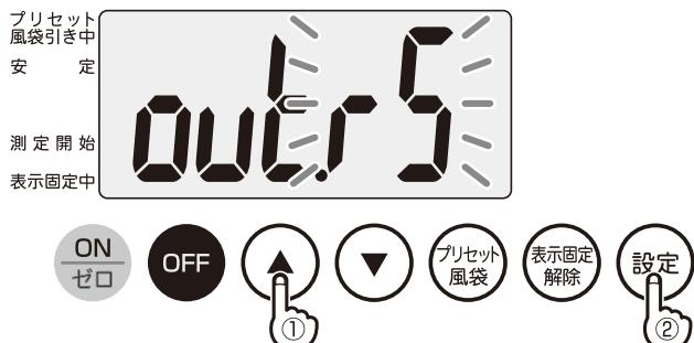
現在の設定（初期設定はRS-232C）が表示され、押すごとに、out Pr（プリンター設定）→ out rS（RS設定）と表示は切り替わり、外部機器が設定できます。
