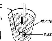
※ポンプ部の給水口が水面から出ないように水の中に沈めます。
